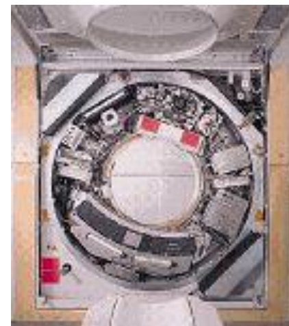
Pohled dovnitř gantry. Ve vrchní části rentgenka, naproti ní obloukovitý detektor.
